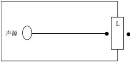
图 4-2 室内声源等效为室外声源图例
